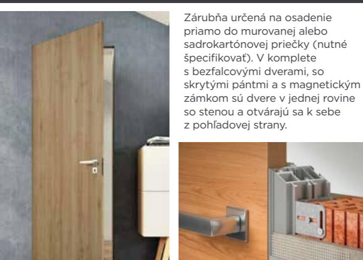
Zárubňa určená na osadenie priamo do muroanej alebo sadrokártónovej priečky (nutné špecifikovať). V komplete s bezfalcovými dverami, so skrytými pántmi a s magnetickým zámkom sú dvere v jednej rovine so stenou a otvárajú sa k sebe z pohľadovej strany.
