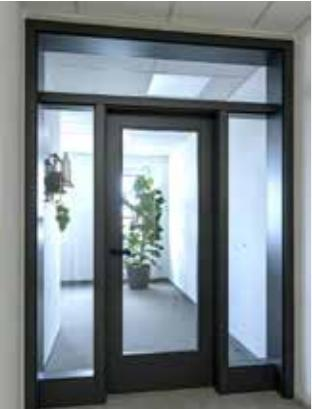
Dverný svetlík je fixný presklený diel, ktorý umožňuje presvetliť priestor za dverami. Svetlíky sú súčasťou zárubne a dajú sa vyrobiť nielen k otočnému, ale aj k posuvnému dverám na stenu.
