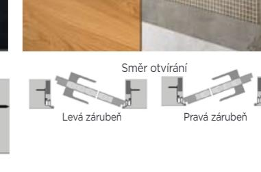
Zárbubeř určená pro osazení přímo do zděné nebo sádrokartonové příčky (nutno specifikovat). V kompletu s bezfalcovými dveřmi, skrytými panty a magnetickým zámkem,
