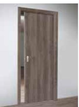
**POSUVNÉ DVEŘE DO POUZDRA** - tato úprava je možná na všech námi nabízených modelech dveřních křídel (kromě dveří SPECIÁLNÍCH) a povrchových úpravách (kromě HPL povrchu). Dělenou zárubeň na posuvné dveře do pouzdra se zasklívacími rámečky nebo s oválnou WC mušlí či mušlí ENTERO dodáváme na příčku o min. tloušťce 12,5 cm. Nutno dodat zaměrovací protokol a specifikaci posuvných dveří, směru otvírání a mušlí.
